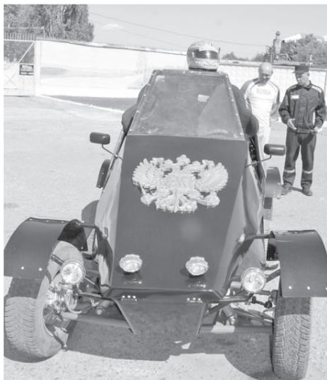
Детали собирали по чертежам, предоставленным заказчиком. Двигатель, часть ходовой и подвеска позаимствованы от «девятки».
